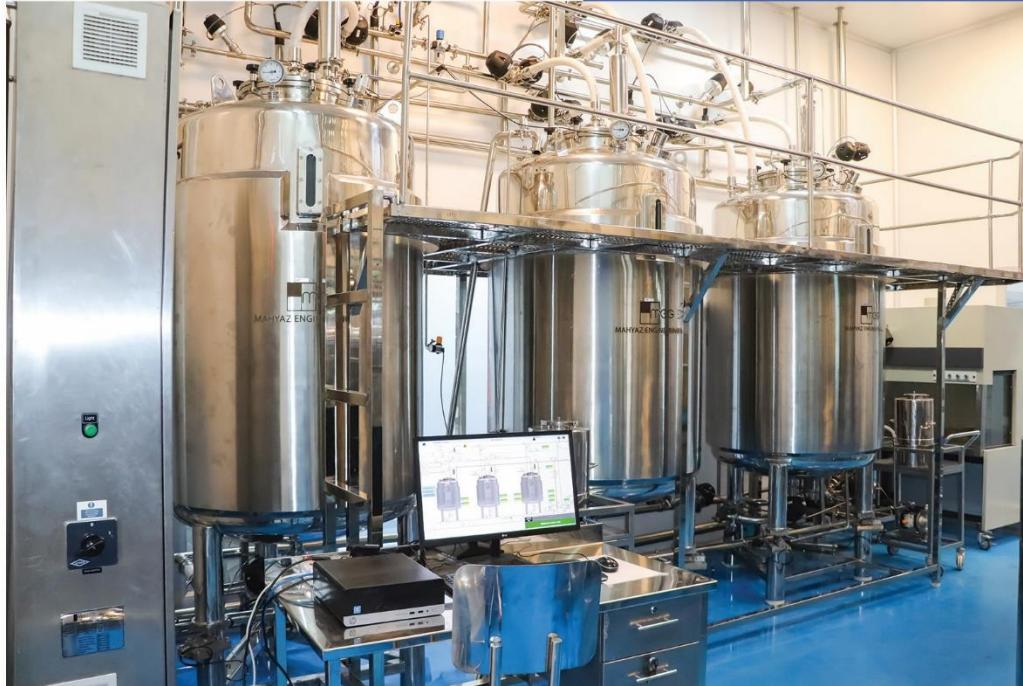
از مهمترین ویژگی های سیستم های SIP تولید شده در شرکت مهندسی مهیاز مقاومت بالای بدنه سیستم در برابر خوردگی، Skid-mounted، طراحی کامپکت، ساختار مواد از SS۳۱۶L، کیفیت بالا و دارای سیستم اتوماسیون قابل سینک به تجهیز مقصود می باشد.
