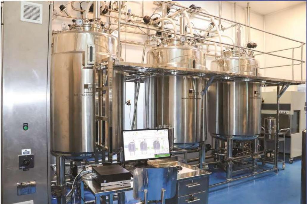
از مهمترین ویژگی های سیستم های SIP تولید شده در شرکت مهندسی مهیاز مقاومت بالای بدنه سیستم در برابر خوردگی، Skid-mounted، طراحی کامپکت، ساختار مواد از SS۳۱۶L، کیفیت بالا و دارای سیستم اتوماسیون قابل سینک به تجهیز مقصد می باشد.
